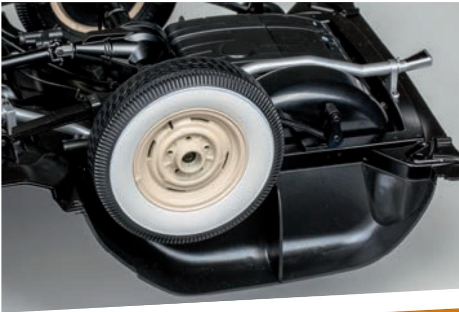
Установите собранное ранее колесо на оси с правой стороны заднего моста. Закрепите колесо сквозь центральное отверстие при помощи винта 2,3×4 с прессшайбой (DM). По окончании монтажа собранное колесо должно оставаться подвижным относительно полуоси заднего моста. Допускается наличие люфта колеса на оси. При необходимости удалите излишки краски из отверстия. Во избежание поломки винта не прилагайте излишних усилий при фиксации деталей.
