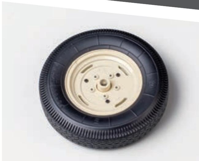
Закрепите собранные детали тремя винтами 1,7×4 (AM) со стороны внутренней части диска. При сборке обратите внимание: четыре щели, расположенные в кольцевом углублении двух половин диска, должны совпасть на внутренней и внешней частях (отверстия должны быть сквозными).
