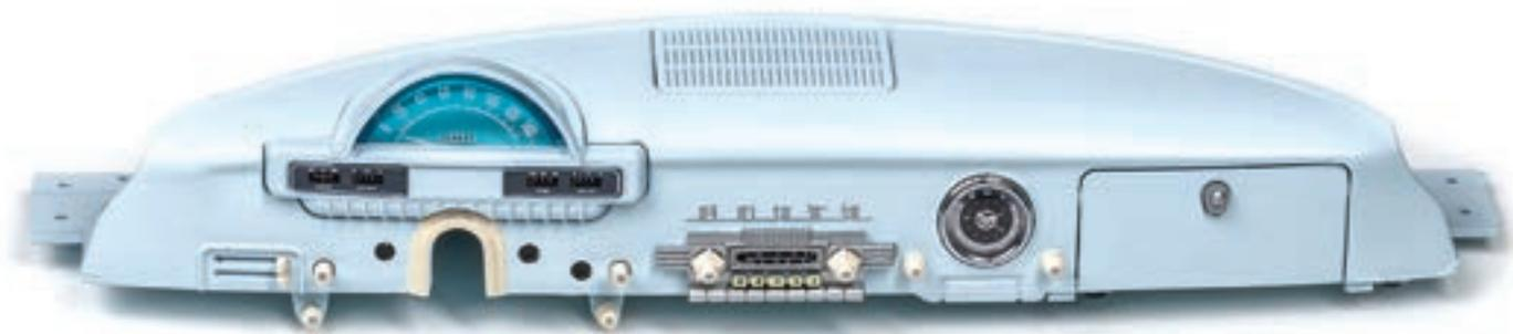
Панель приборов в сборе с вещевым ящиком
