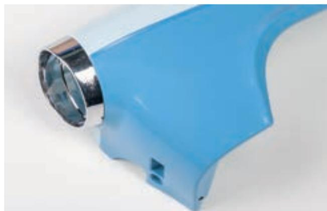
В отверстие переднего торца крыла расположите ободок фары. В верхней части посадочной плоскости ободка имеется центровочная метка. Ответный центровочный штифт также отлит в верхней части отверстия на крыле. Совместите центровочные метки и установите деталь на место. На данном этапе ободок фары никак не фиксируется в крыле (допускается неплотная посадка).
