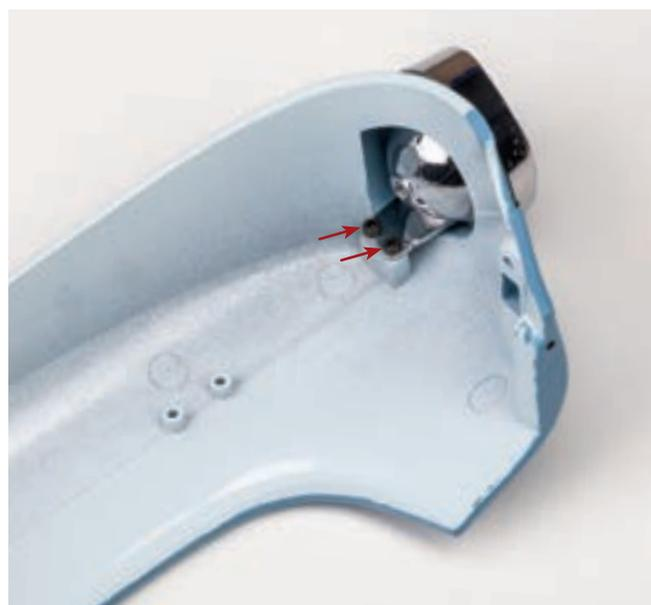
Внутрь ободка поместите корпус левой фары. Совместите крепежные отверстия на кронштейне корпуса фары с ответными элементами, расположенными на внутренней поверхности переднего левого крыла, и зафиксируйте корпус и ободок фары при помощи двух винтов 2,0×5 (СМ).
