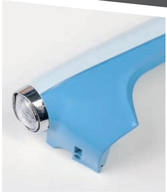
Внутри корпуса фары поместите стекло. Обратите внимание на положение центровочных меток на торцевой поверхности стекла и внутренней поверхности корпуса фары. Совместите метки и плотно вставьте стекло в корпус фары.
